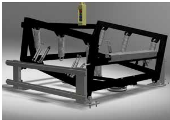
Система фронтального и заднего опрокидывания для упрощения процесса загрузки и разгрузки белья в машинах с большой вместимостью (60 и 120 кг). / Front and back tilting system for an easy and quick loading / unloading in big capacity machines (60 and 120kg).
